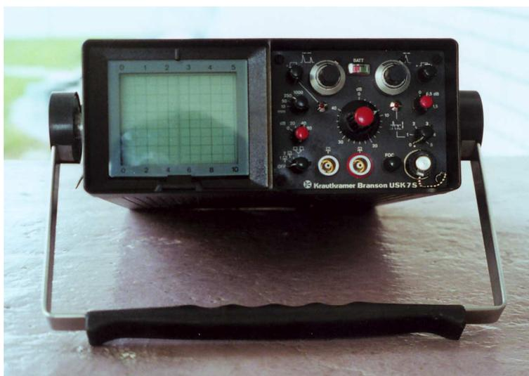
圖10 超音波檢測儀器
