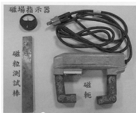
圖 10 手提式磁粒檢測儀器
