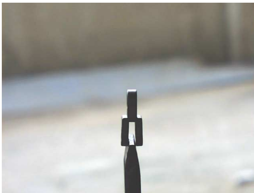
圖 22 溝槽間隙變小，以有斜度之整型塊撐開整型
