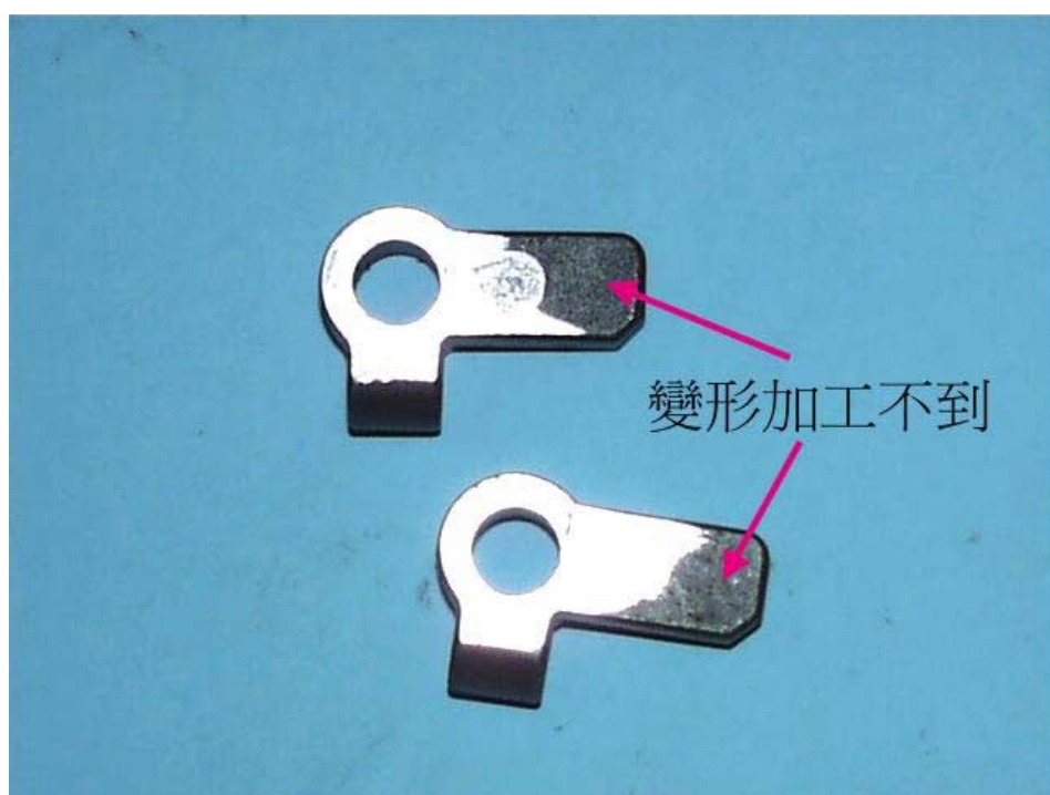
圖 15 彎曲變形加工不良品
