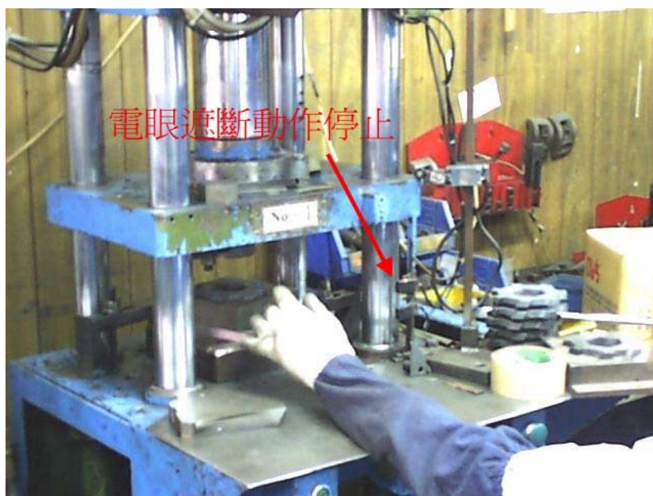
圖 28 安全防護設備電眼遮斷即無法動作
