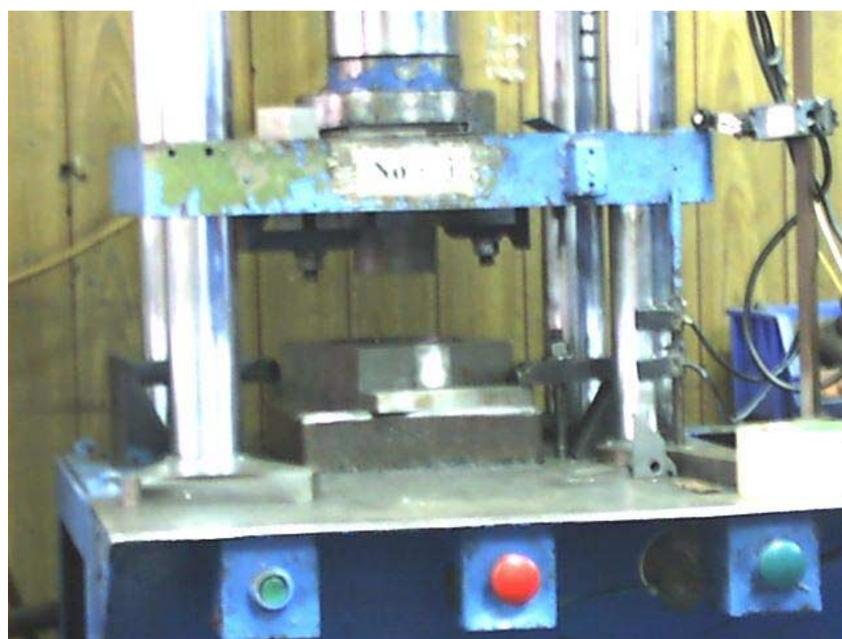
圖 29 整型模具固定於整型設備上
