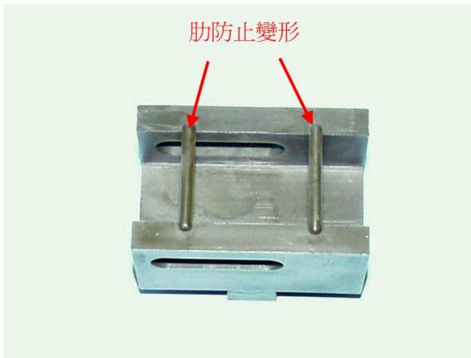
圖 18 加防止變形肋以防蠟型變形
