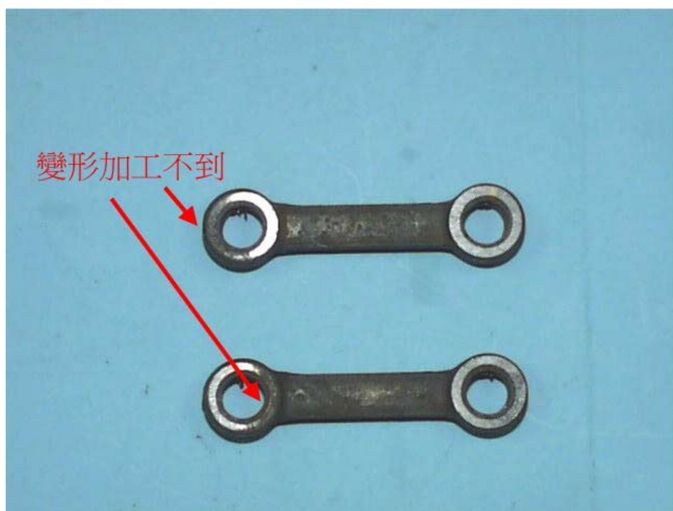
圖 15 彎曲變形加工不良品
