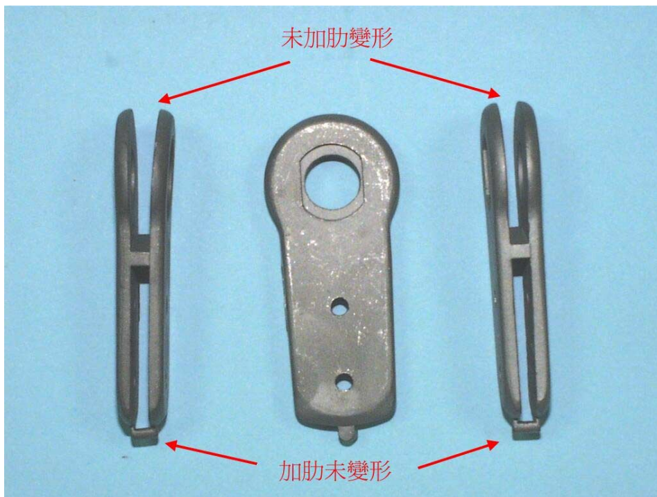
圖 4 未加肋補強造成變形
