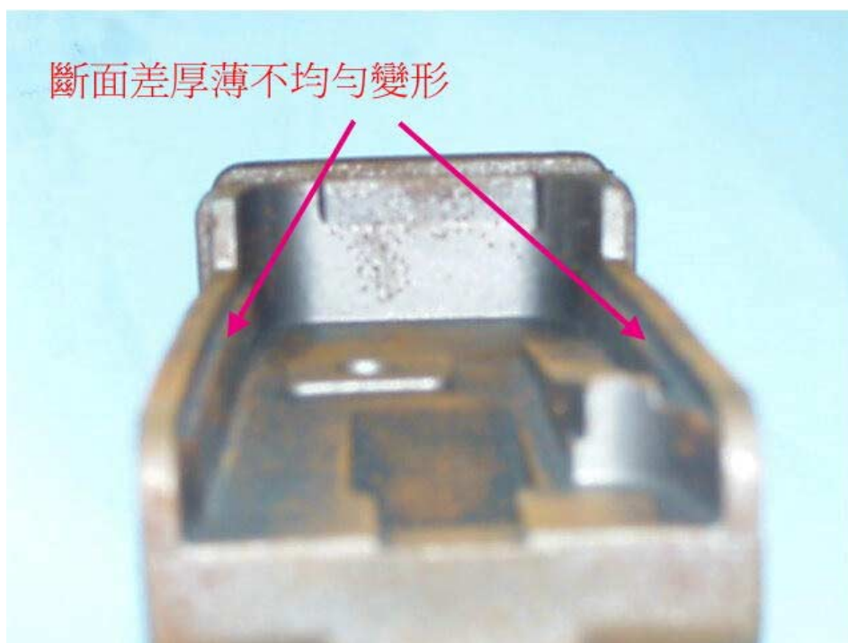
圖 2 鑄件肉厚斷面差厚薄不均勻凝固收縮造成變形
