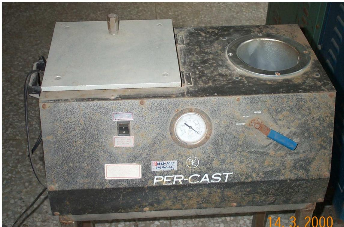
圖 12 真空減壓鑄造設備
