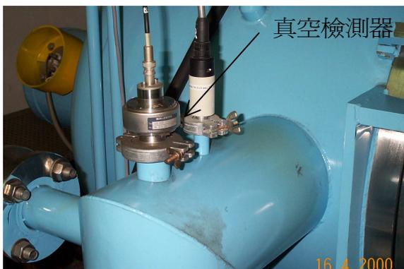
圖 7 真空檢測系統
