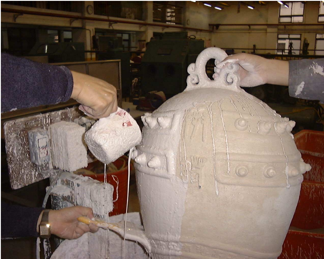
圖 16 淋泥漿（矽酸乙酯四十 + \text{SiO}_2 粉）
