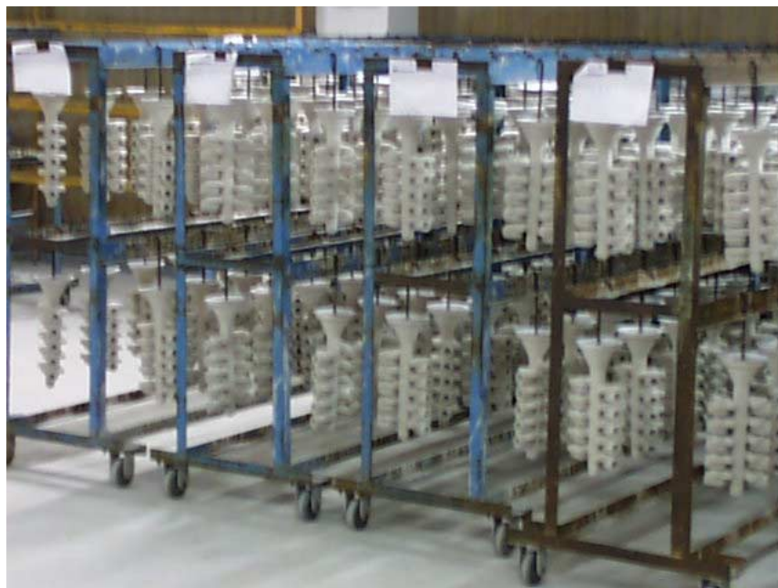
圖 7 典型精密鑄造之陶瓷殼模法
