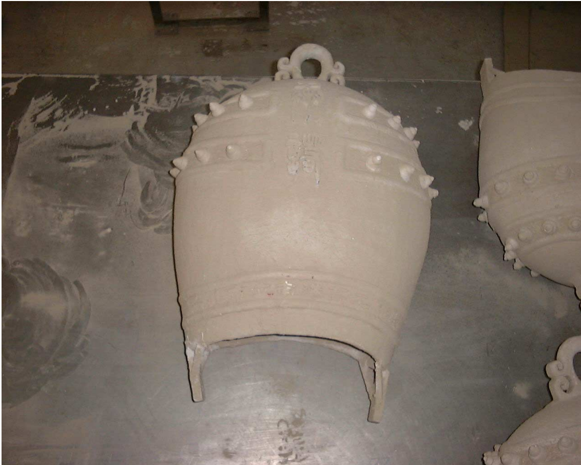
圖 6 第一層泥漿及 \text{SiO}_2 粉附著於消失模上
