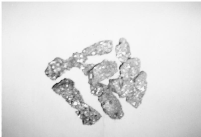
圖 7 低碳鉻鐵 Cr 62%粗大晶粒具金屬光澤
