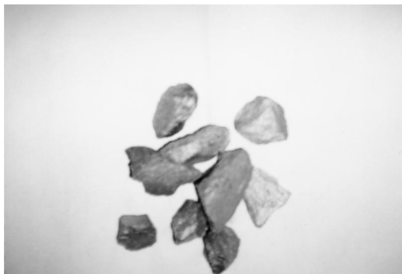
圖 8 低碳鉬鐵 Mo 60%結晶細密具有金屬光澤
