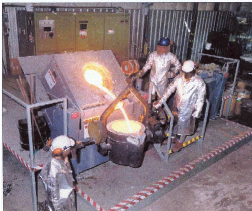
圖 22 無芯式鋁殼爐熔解作業
