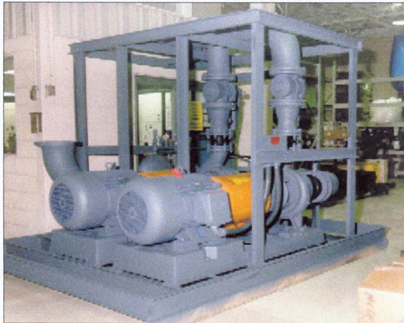
圖 35 外水鑄鐵泵浦組
