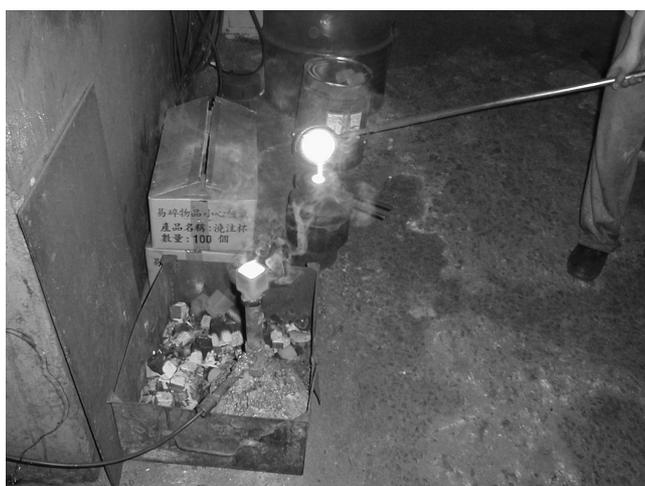
圖 31 鐵水取樣，檢測球化率及分光分析
