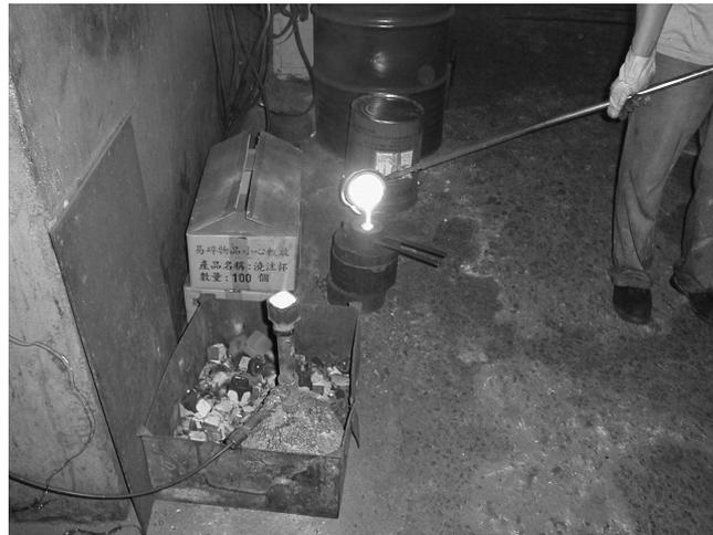
圖 14 鐵水取樣，測定碳當量及澆鑄分光儀試片
