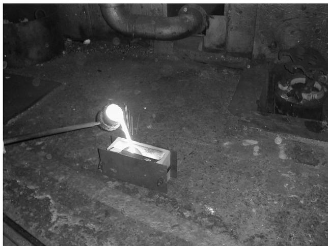
圖 33 澆鑄 Y 型 BLOCK 試片
