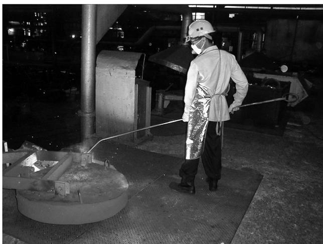
圖 19 使用浸入式測溫計測定出湯溫度
