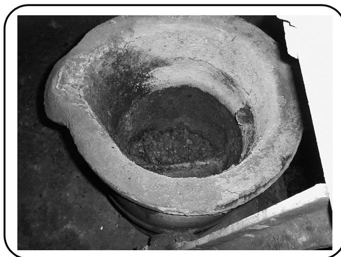
圖 22 球化劑放入球化桶的合金坑內
