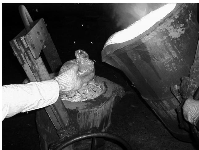
圖 28 接種劑投入澆盆的情形
