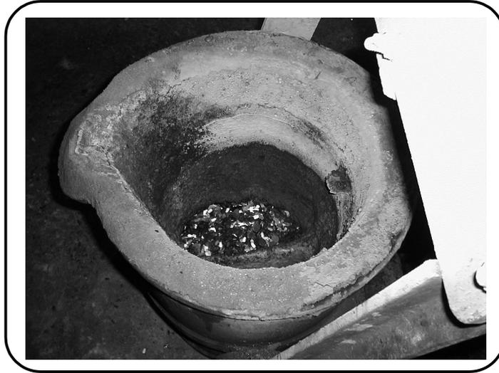
圖 23 球化劑上覆蓋細、薄的矽鋼片
