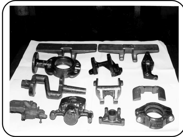
圖 5 採用球墨鑄鐵鑄造的各種另件
