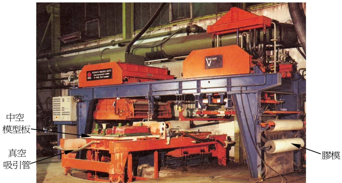
圖 48 真空造模機械設備
