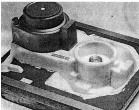
圖 72 脈沖式造模法之模型板
