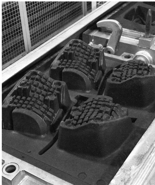
圖 59 高壓衝氣造模法所製造的砂模
