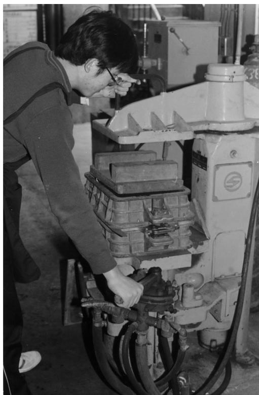
圖 31 壓擠造模時右手握壓擠開關左手扶持壓擠板把手
