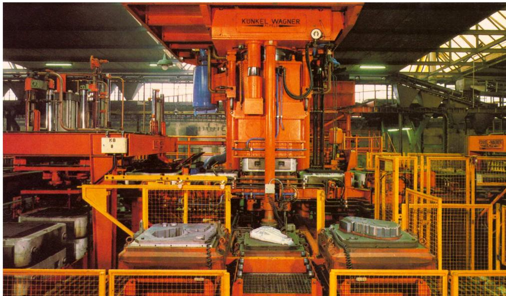
圖 68 真空加壓法之造模設備及模型板
