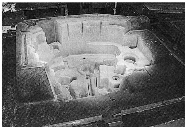
圖 18 機械造模製作之上砂模
