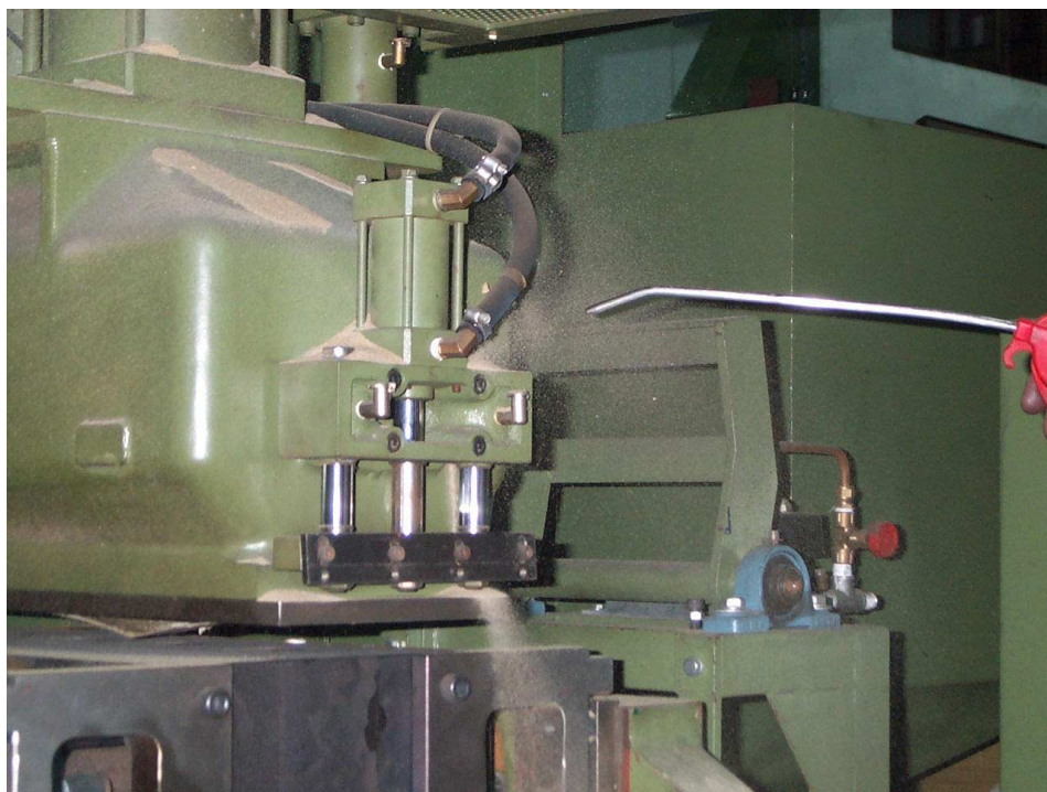
圖 18 用空氣噴槍把氣缸上落砂清除
