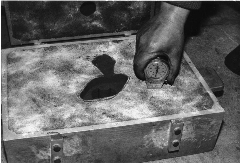
圖 22 濕砂模模面硬度測試情形
