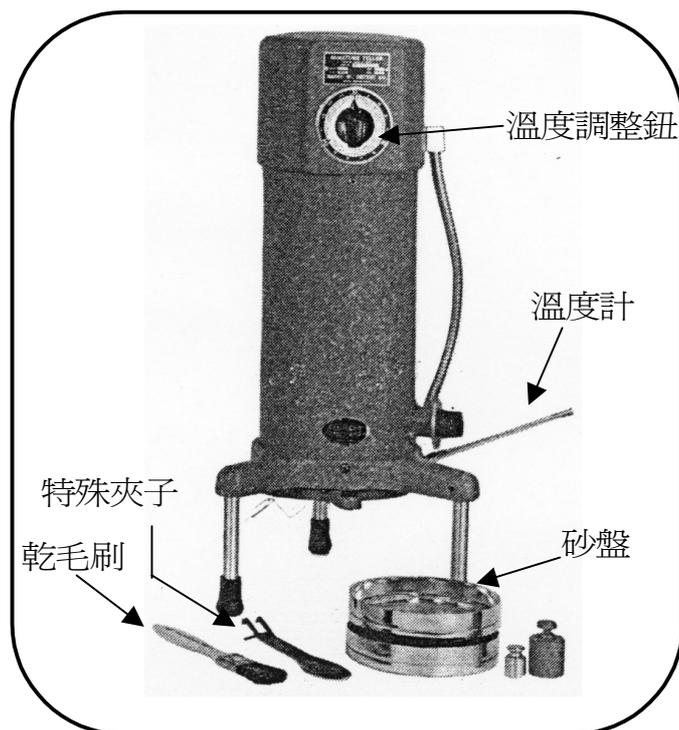
圖 8 水分含量測試器及附件
