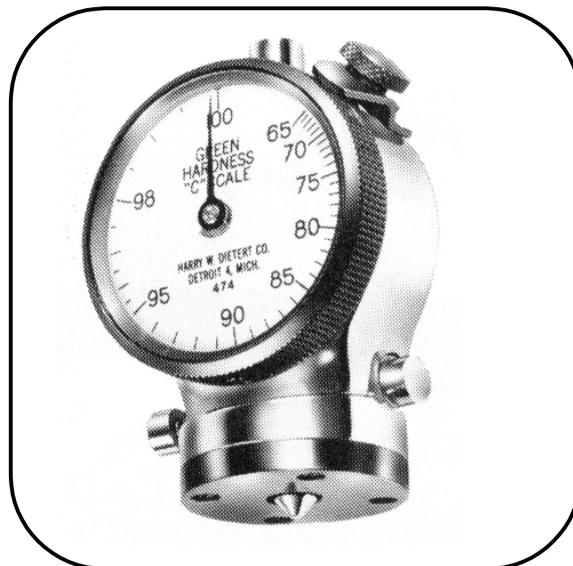
圖 20 “C 型” 濕砂模硬度計
