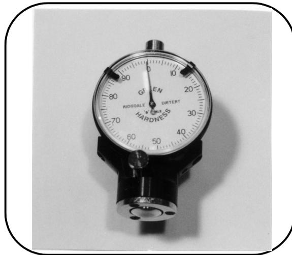
圖 19 “B 型” 濕砂模硬度計及其底部壓痕球
