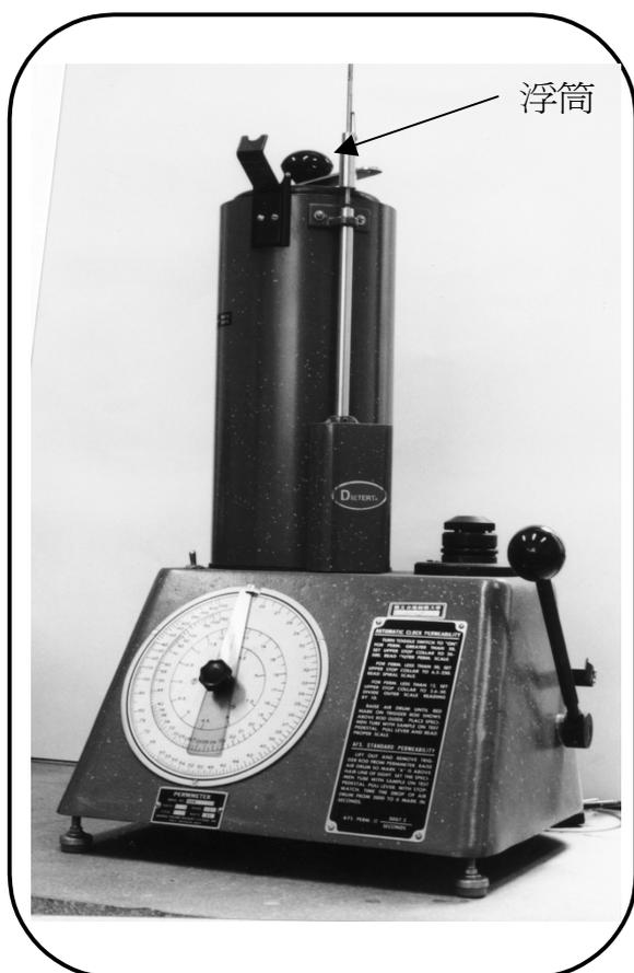
圖 15 浮筒型鑄砂透氣度測試器
