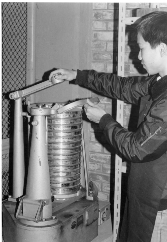
圖 14 扣緊篩網及轉回錘桿後才可啓動電源
