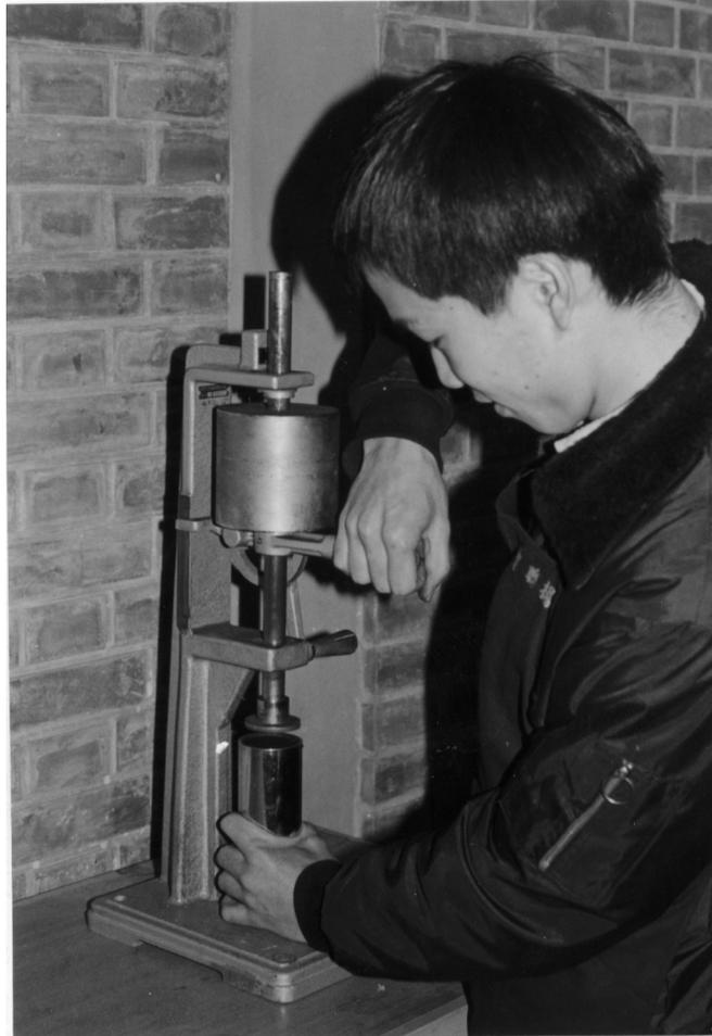
圖 6 抬高錘桿，將試片管安置固定孔座上
