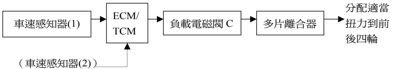
除了以上的兩個電路控制元件外，另外有一個車速感知器(2)，在綜合儀表內靠近速度表，隨著內軸旋轉產生脈衝信號，而將信號傳送到(ECM/TCM)，它是在車速感知器(1)故障時，作為備份時使用。
