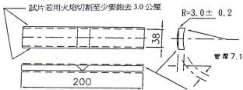
圖示係背彎試片磨去面側
