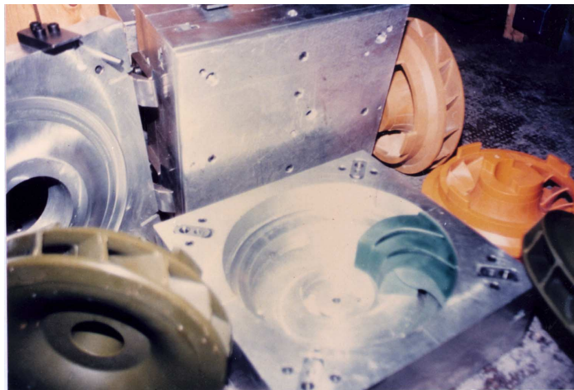
圖 51 葉輪蠟模、形成葉片之水溶性蠟心及上下模具
