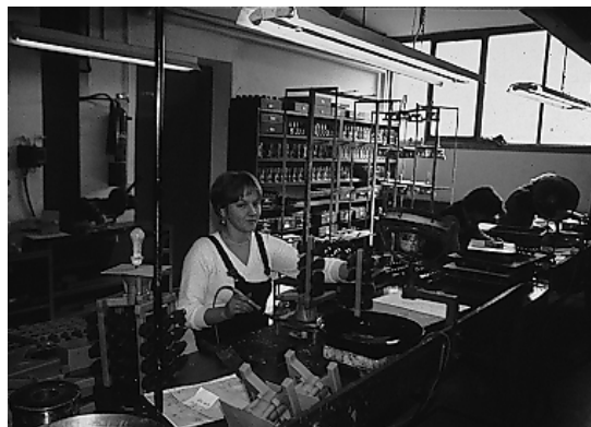
圖 22 組立蠟樹之三～焊合澆口杯（蠟樹頭）
